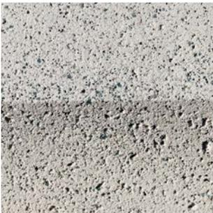
Wasserhöchstdruckabtrag (Beton mit  $D_{max}$  16)
