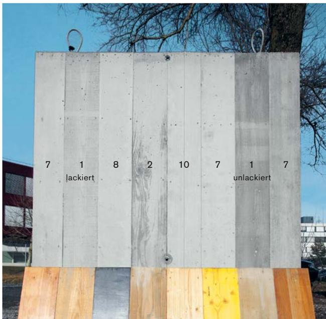
Bei strukturierter (texturierter) Schalhaut fallen Lunker und Farbtonunterschiede weniger stark als bei nicht texturierten Schalhautoberflächen auf.
